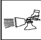
2. APPUYER A FOND SUR LE LEVIER DE COMMANDE VISER LA BASE DES FLAMMES
