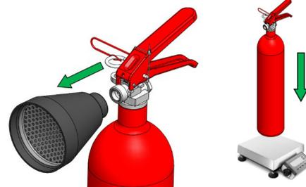
Si le poids de l'extincteur est correct, remonter le cone en remplaçant le joint.
